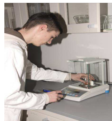
Slika 1: Tehtanje na analizni tehtnici
